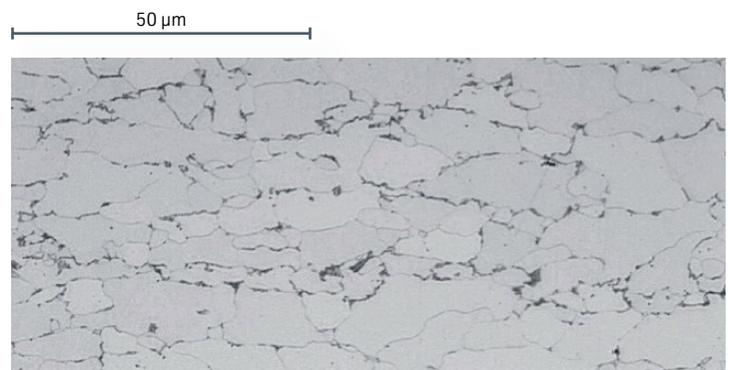
Beispielgefüge kaltgewalzter mikrolegierter Stähle: Gefügekontrastierung über Ätzung mit Nital.
